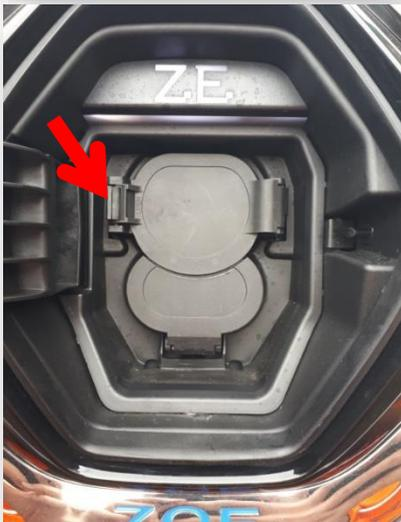
**Haltemechanismus** zur Seite ziehen und die Staubklappe öffnet sich automatisch.
