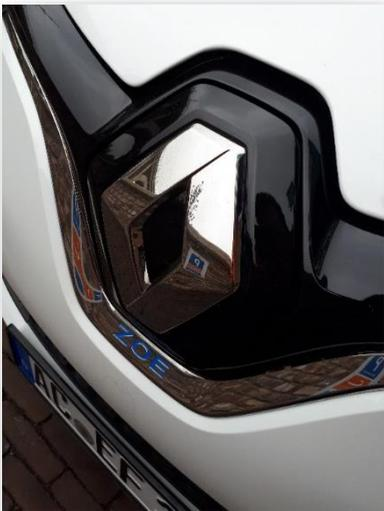
**Logoklappe** schließen bis diese eingerastet ist.
