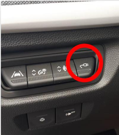
Die Taste mit dem **Steckersymbol** drücken, um die Ladeklappe zu entriegeln.
