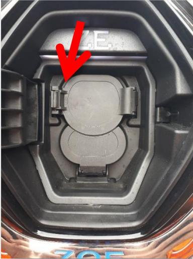
Die **Staubklappe** schließen bis diese eingerastet ist.
