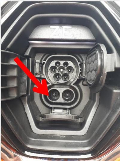
Der untere Ladeanschluss ist für das **DC Schnellladen** (CCS Standard). Das Ladekabel samt Normstecker befindet sich an der jeweiligen Schnellladesäule.
