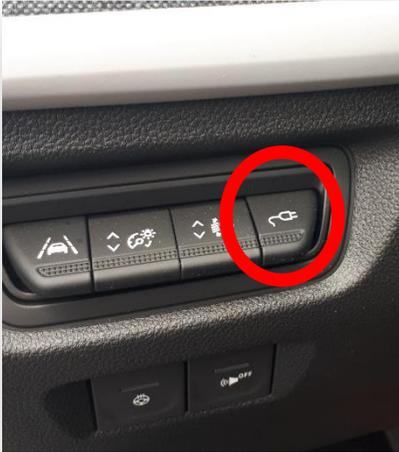
Im Fahrzeug, links vom Lenkrad, die Taste mit dem **Steckersymbol** drücken, um das Ladekabel zu entriegeln.
