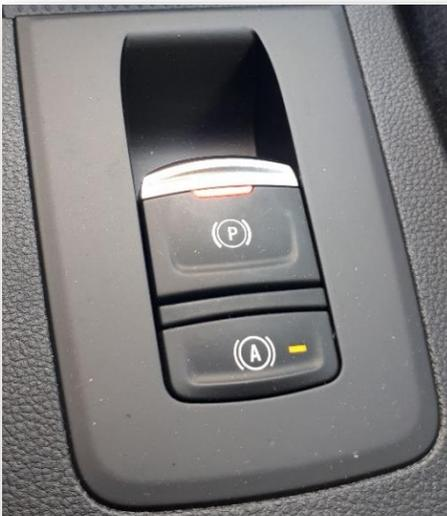
**Parkbremse** löst und zieht automatisch an, kann auch manuell bedient werden:
