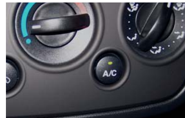
Die Klimaanlage ist nur aus, wenn das Licht im A/C-Schalter nicht leuchtet.
